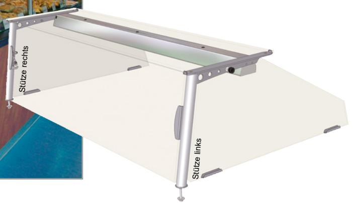
Zur einfachen Reinigung kann die Frontscheibe gedreht werden!
