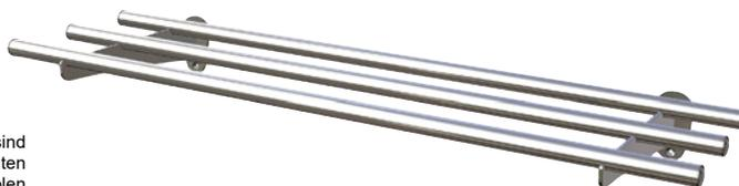
Rohre und Anschraubkonsolen aus Edelstahl 1.4301. Die Anschraubkonsolen sind jeweils mit 3 Löchern, Durchmesser 6 mm, zum Anschrauben an Thekenfronten versehen. Die 3 Edelstahlrohre (D=25 mm x 2 mm) sind fest mit den Konsolen verschweißt. Die Rohrenden sind mit farblich passenden Kunststoffstopfen verschlossen.
